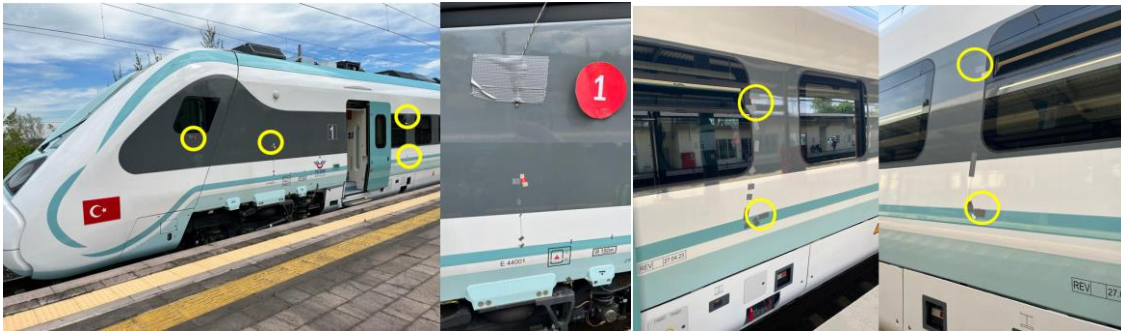
Şekil 9. Milli EMU yol testleri aerodinamik veri toplanması
