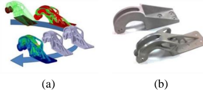
Şekil 11. Airbus A320 kabin menteşe braketinin topoloji optimizasyonu (solda) ve eklemeli imalatı (sağda) (Blakey vd. 2021)
