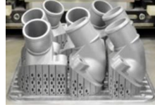
Şekil 29. 3B baskılı termostat kapakları (Green Car Congress, 2017)
