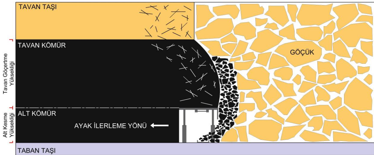
Şekil 1. Göçertmeli Uzunayak Yöntemi
