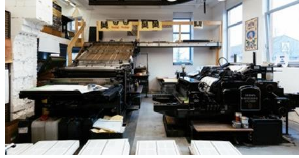
Görsel 19. P98a'dan ayrıntıda solda Johannisberger kazanlı (96 x 130 cm) ve sağda Heidelberg kazanlı (50 x 70 cm) tipo baskı makinasına, 2017, Berlin.
