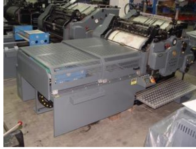
Görsel 6. Sıcak yaldız makinasına dönüştürülmüş Heidelberg SBG modeli kazanlı tipo baskı makinası, 2023, İstanbul.
