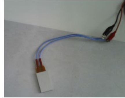
Şekil 7. Elektrikli ısı kaynağı.
