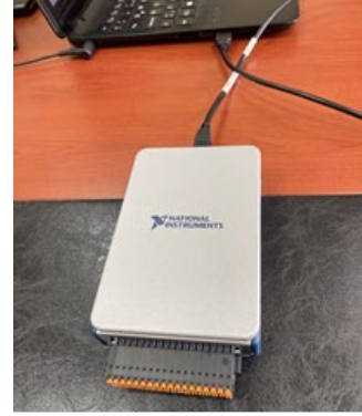
Şekil 6. NI 9220 data kazanım kartının görünümü.
