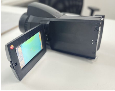
Şekil 9. Termal kamera (Testo 885).
