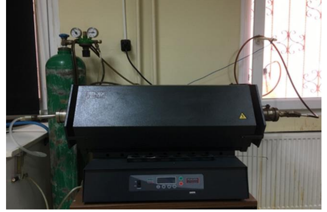
Şekil 3. Aktif karbon üretimi çalışmalarında kullanılan akışkan yataklı termoreaktör.
