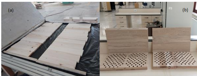
Şekil 1. (a) Lamine ahşap levhaların oluşturulması, (b) Ara katmanlarda kullanılacak perforasyonlu lamine ahşap levha
