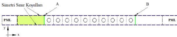
Şekil 4. a) Boş uzaydaki birim hücredeki dikdörtgen örgü içindeki fononik kristal b) ters örgü indirgenemez Brillouin Bölgesi yüksek simetri noktaları ( \Gamma -X-M).
