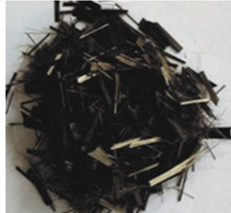
Şekil 2. Çalışmada kullanılan ayrıştırılmamış BF.
