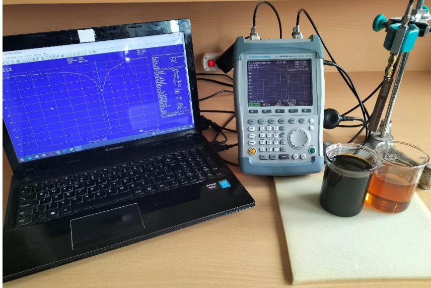
Şekil 4. Geri Dönüş Kaybı Ölçümleri İçin Motor Yağı Numune Ortamı ve Önerilen Antenin Motor Yağı İçerisindeki Farklı Uzunluk Seviyeleri(a) ile Sensör Ölçüm Düzeneği (b) (Engine Oil Sample Medium for Return Loss Measurements and Sensor Measurement Setup (b) with Different Length Levels of the Proposed Antenna in Engine Oil (a))
