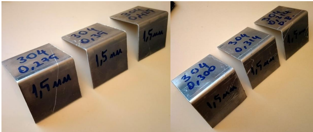
Şekil.6. 1,5 mm AISI 304 kalite paslanmaz çeliğinin verilen k-faktörlerine göre bükümleri.
