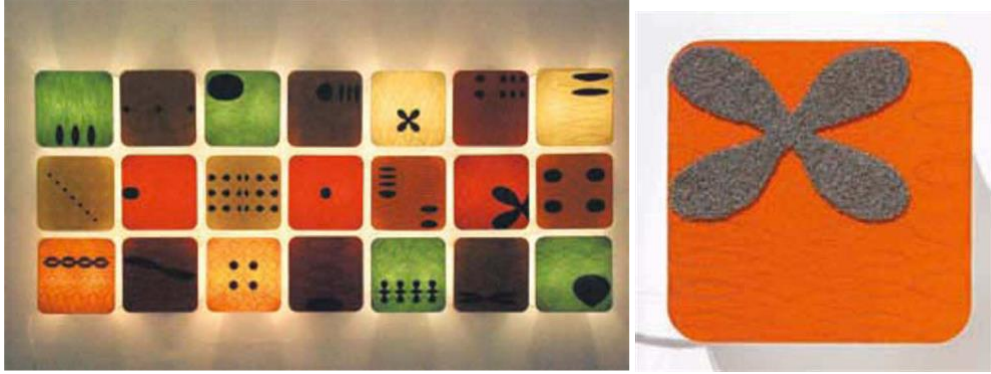
Görsel 8. Nakış ile Tekstil Yüzeyine Uygulanan İletken İplik ile Oluşturulan Işık Mekanizması.
