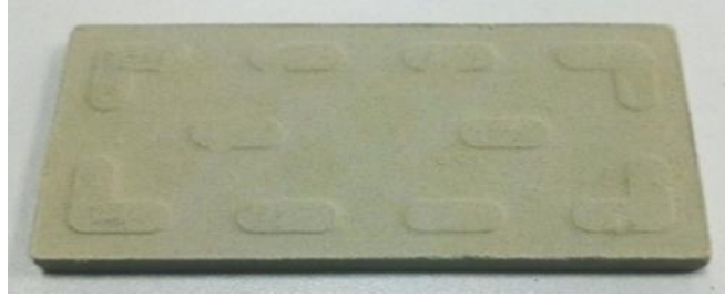
Şekil 1. Presten çıkan olivin esaslı tuğla.
