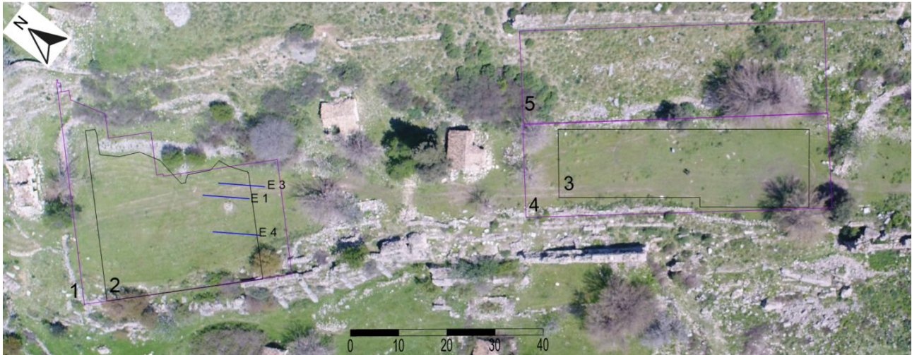
Şekil 6. Stadyum bölgesinde düşey gradiyometrik manyetik, öz direnç ve jeoradar ölçümlerinin alındığı alanlar (1) stadyum kuzey manyetik, (2) stadyum kuzey yer radarı, (3) stadyum orta yer radarı, (4) stadyum orta zemin manyetik, (5) stadyum orta tribün manyetik
