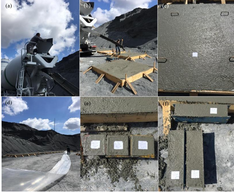
Şekil 5. Deney plaklarının beton dökümleri ve kütleme işlemleri. (a) Beton dökümü (b)-(c) Kalıplar ve plakalar (d) Kütleme işlemi (e) Küp numuneler (f) Kiriş numuneler.
