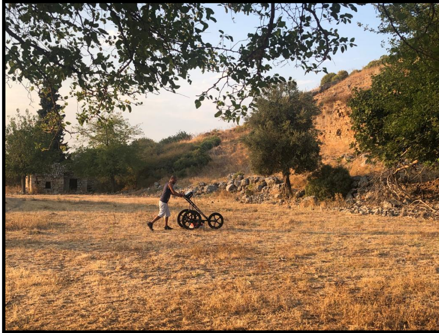
Şekil 4. GSSI SIR-3000 yer radarı cihazı ile stadyum bölgesinde ölçü alımı Figure 4. Measurement in the stadium area with GSSI SIR-3000 ground penetration radar
