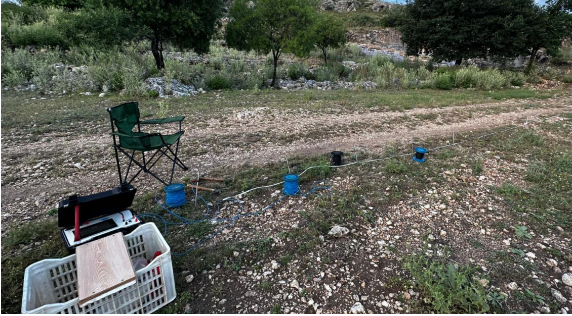
Şekil 5. Geoves marka cihaz ile stadyum bölgesinde ölçü alımı Figure 5. Measurement in the stadium area with Geoves
