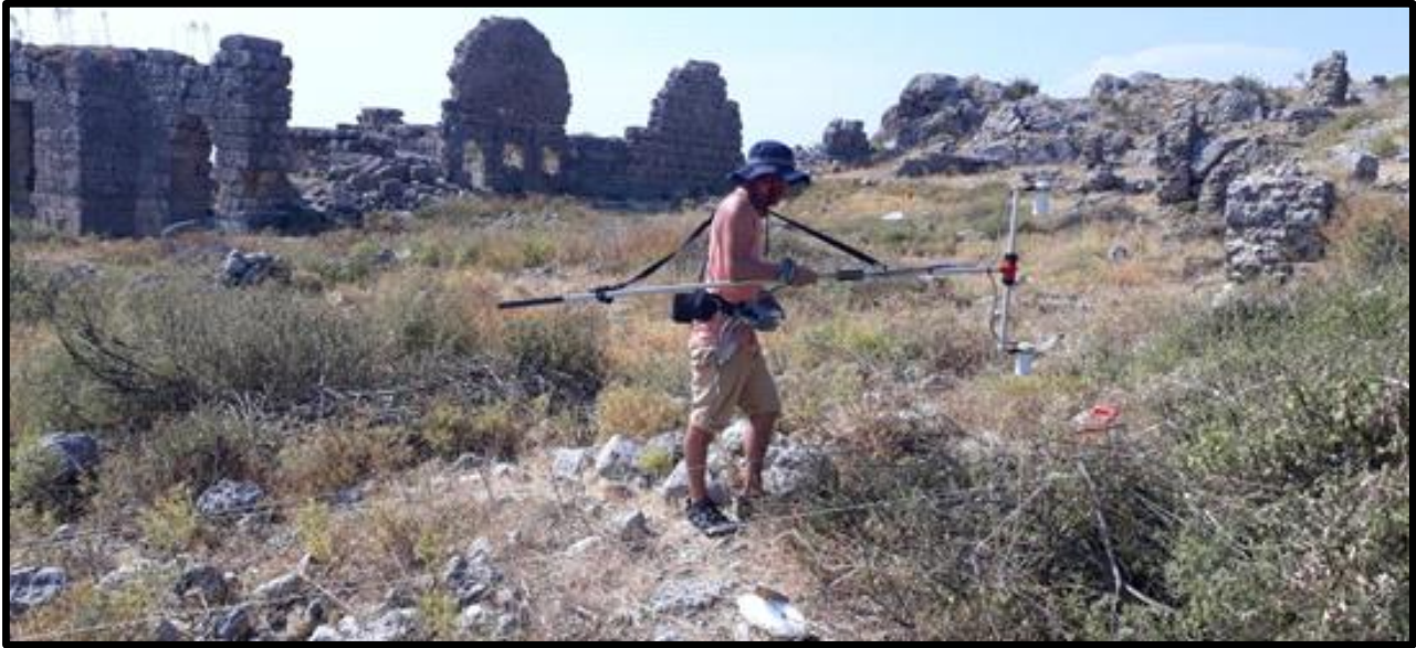
Şekil 2. Geometrics G-858 sezyum manyetometresi ve ölçüm alımı
