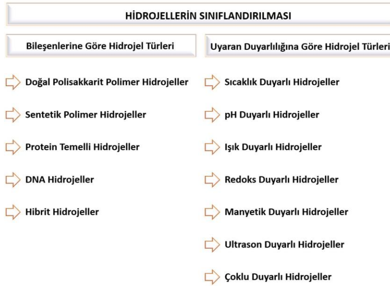
Şekil 1. Hidrojellerin bileşen yapılarına ve uyaran duyarlılığına göre sınıflandırılması
