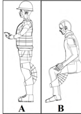
Şekil 8: Diz destek sistemi oturup kalkma durumunda çalışma prensibi. A: Ayakta durma detayı. B: Oturma durumu detayı.
