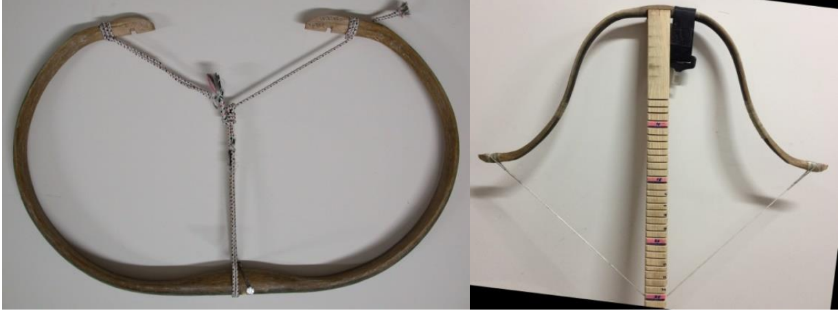
Şekil 4. Türk Yayı Yapım Aşamalarından İki Örnek; Halkaya Çekme ve Asa Gezinde Yayın Açılması (S.Parlak, 2022). Figure 4. Two Examples of Turkish Bow Making Stages: Pretzel Shape for Seasoning and Tillering in Asa Gez (S.Parlak, 2022).
