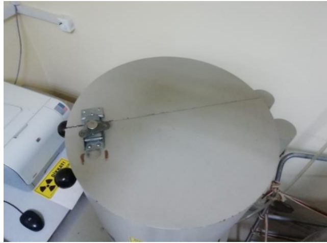
Şekil 1. HPGe dedektörüne ait zırhlı numune odasının yandan (sol panel) ve üstten (sağ panel) görünümü.
