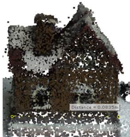
Şekil 7. Ev biblosu el tipi lazer tarama yöntemiyle elde edilen uzunluk ölçüsü.
