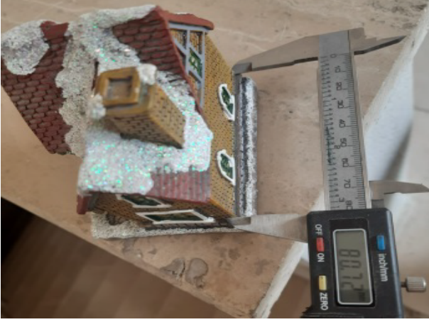
Şekil 8. Ev biblosu elektronik kumpasla elde edilen uzunluk ölçüsü.
