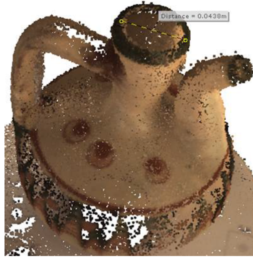
Şekil 6. Vazo objesinden el tipi lazer tarama yöntemiyle elde edilen uzunluk ölçüsü.
