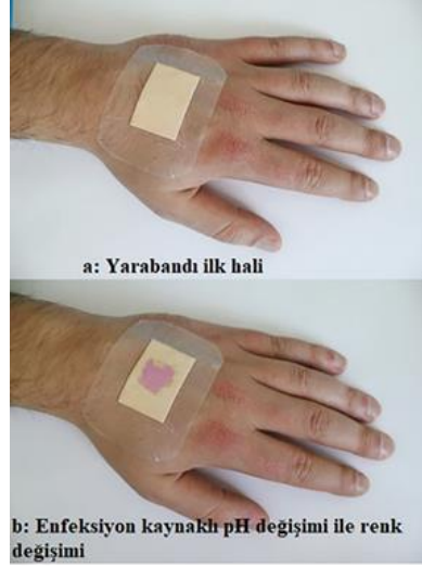
Şekil 4. Enfeksiyon kaynaklı pH değişimine duyarlı iyonokromik yara bandı (Van der Schueren & Clerck, 2012, s.85)
