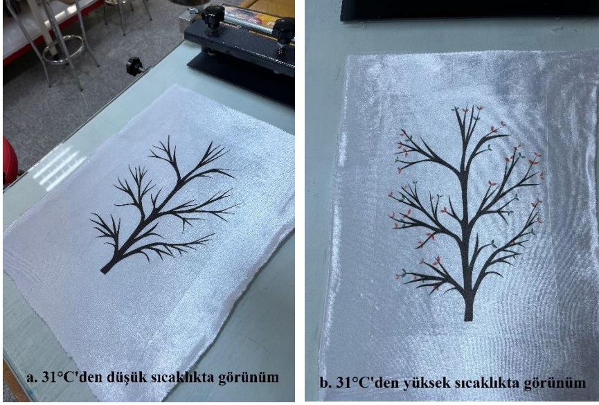
Şekil 19. Sıcaklık artışı ile termokromik değişimin gözlenmesi
