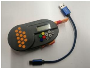
Şekil 2. Dijital kablosuz aktarım özellikli mezura
