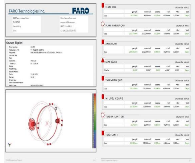
Şekil 15. Döküm gövdeye ait hassas ölçüm raporu
