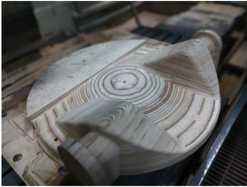
Şekil 13. Yeni tasarım klape ahşap model üretimi
