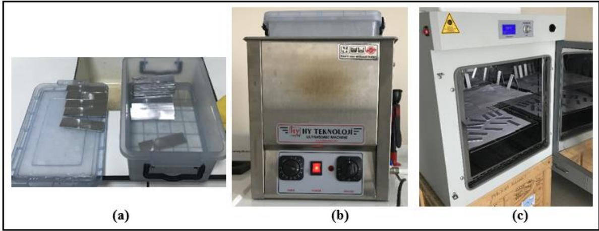
Şekil 1. Alüminyum parçalara uygulanan temel yüzey işlemleri, a) Zımparalama işlemi sonrası, b) ultrasonik titreşim altında asetonla temizleme, c) etüvde kurutma işlemi.
