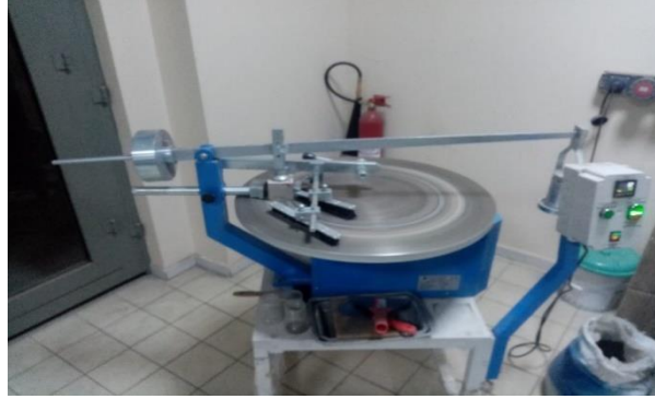
Şekil 5. Böhme aşındırma cihazı
