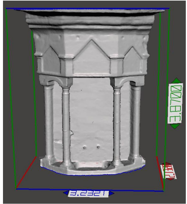
Şekil 5. 3B modelin Autodesk Meshmixer'da düzenlenmesi.
