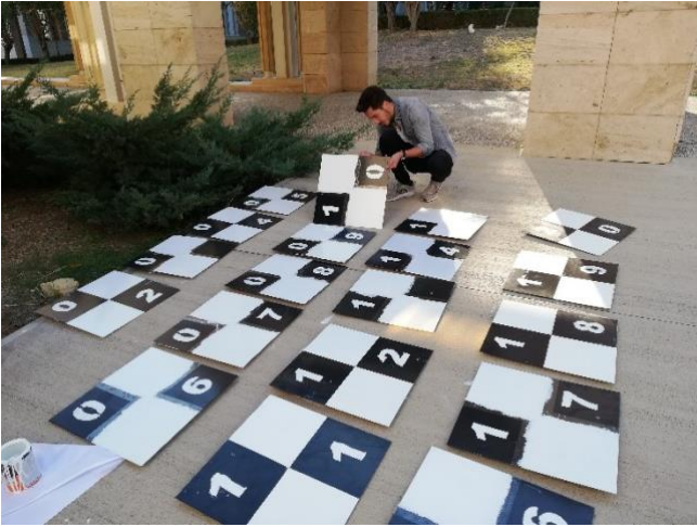
Şekil 2. DFP, YKN ve KN noktalarının hazırlanması.
