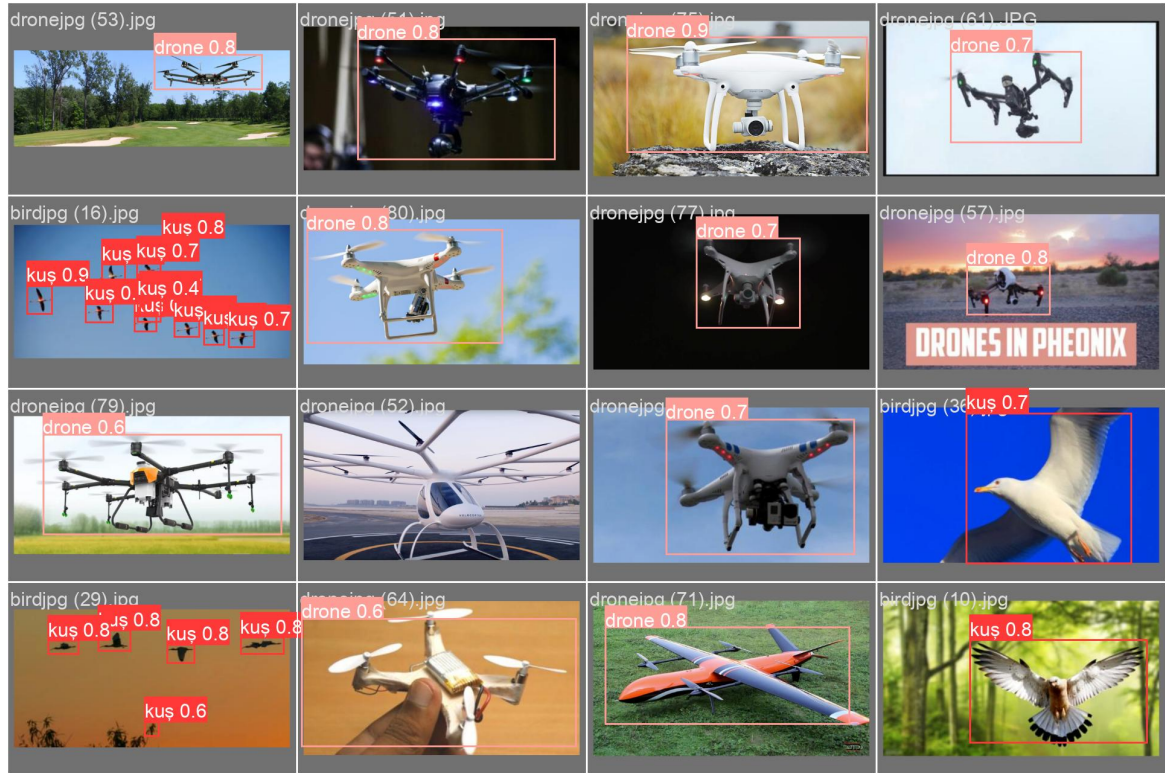
Şekil 5. Derin öğrenme modeli ile tespit edilen drone görüntüleri (Drone images detected with the deep learning model)
