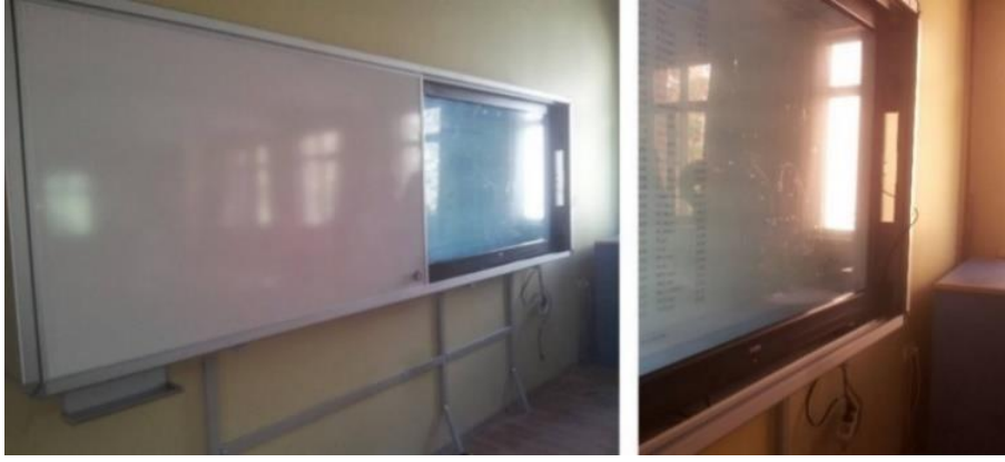
Şekil 11. Dijital ekran entegreli derslik tahtasında oluşan yansımalar (Donanım Haber, 2012).
