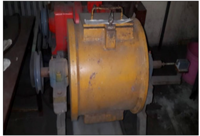
Şekil 9. Bond bilyalı değirmen deney aleti.
