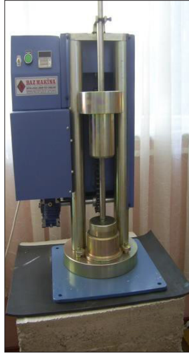
Şekil 3. Kırılganlık deney aleti.
