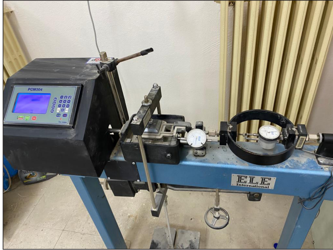
Şekil 7. Kesme kutusu deney cihazı.
