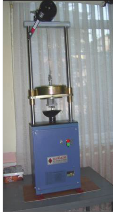
Şekil 4. Sievers J minyatür deney aleti.
