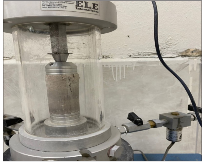
Şekil 6. Kaolin kiline uygulanan serbest basınç deneyi.
