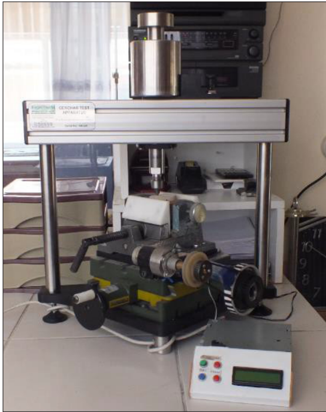
Şekil 5. West tam otomatik CAI deney aleti.
