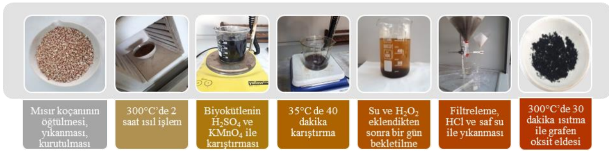
Şekil 1. Mısır Koçanından Elde Edilen Grafen Oksit Adsorbent ve Katalizör Destek Malzemesi Hazırlanış Adımları
