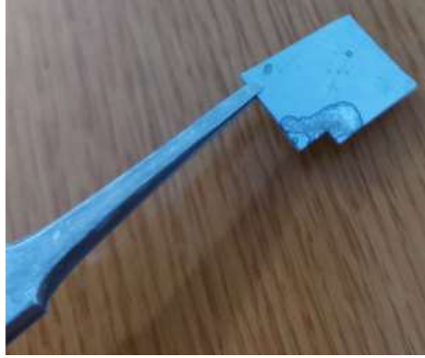
Şekil 11. 1035 °C’de 60 Dakika Sentezlenen Borofen Yüzey Yapısı
