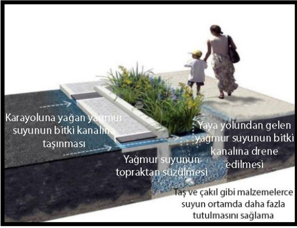
Şekil 4.3 Yüzeysel akışı sağlayan bioswale uygulaması (Kavuran 2021)
