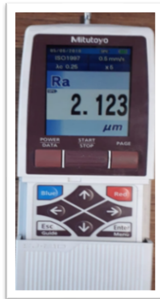
Şekil 5. Yüzey pürüzlülük ölçüm cihazı (Surface roughness measuring device)
