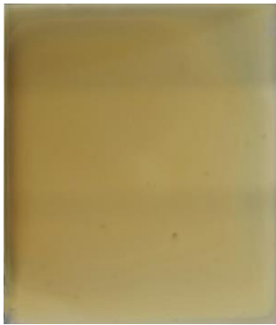
Görsel 8. Emülsiyon kaplanan cam yüzey
