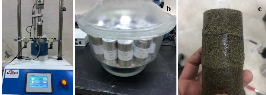
Şekil 7. Serbest Basınç Deneyleri, (a) serbest basınç deney aleti, (b) numunelere uygulanan desikatör kürü, (c) deney sonrası numuneleri görünümü
