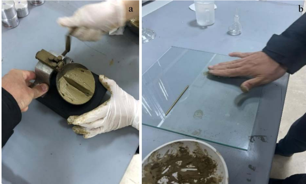
Şekil 4. Zeminin sınıfının belirlenmesi için uygulanan atterberg limit deneyleri (a) likit limit (b) plastik limit
