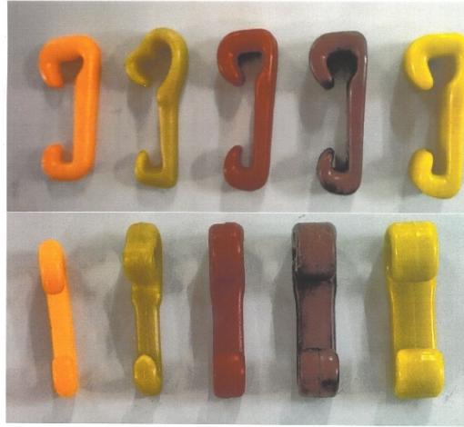
Şekil 4. Kalın iplik üretimi için tasarlanıp üretilen kopça örnekleri
