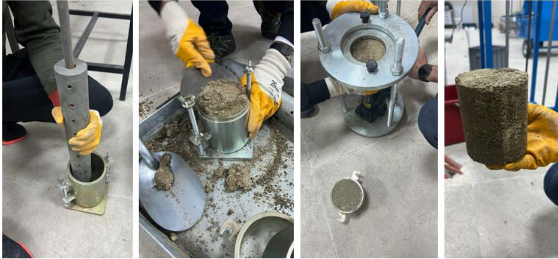
Şekil 5. Proktor deneyi uygulaması
