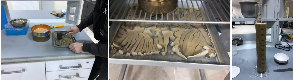
Şekil 3. Zeminin granülometrisi çıkartılma işlemleri
