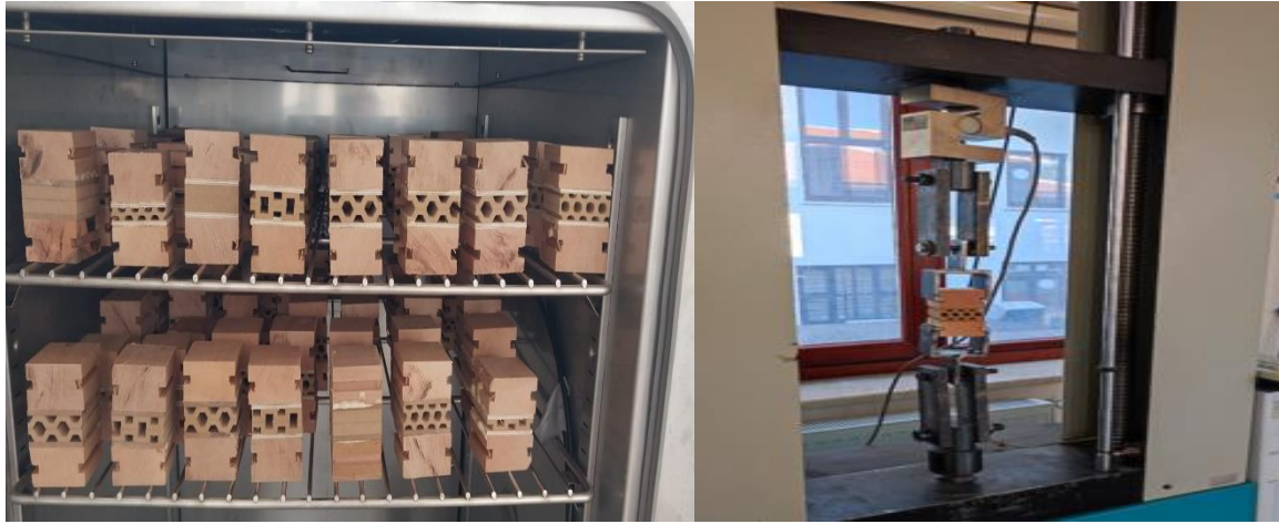
Resim 2. Deney Numunelerinin iklimlendirilmesi ve çekme kuvvetinin uygulanması
