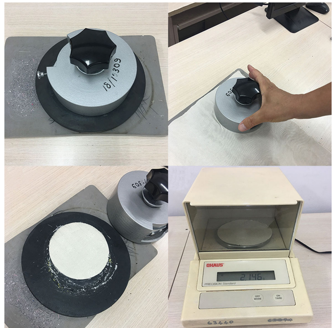
Görsel 7. Tasarımda Kullanılan Kutnu Kumaşın Metrekare Ağırlığının Ölçümü; 100 cm 2 lik Şablon, Kesim İşlemi, Kesilmiş ve Tartıma Hazır Kutnu Kumaş, Hassas Terazi ile Tartım.
