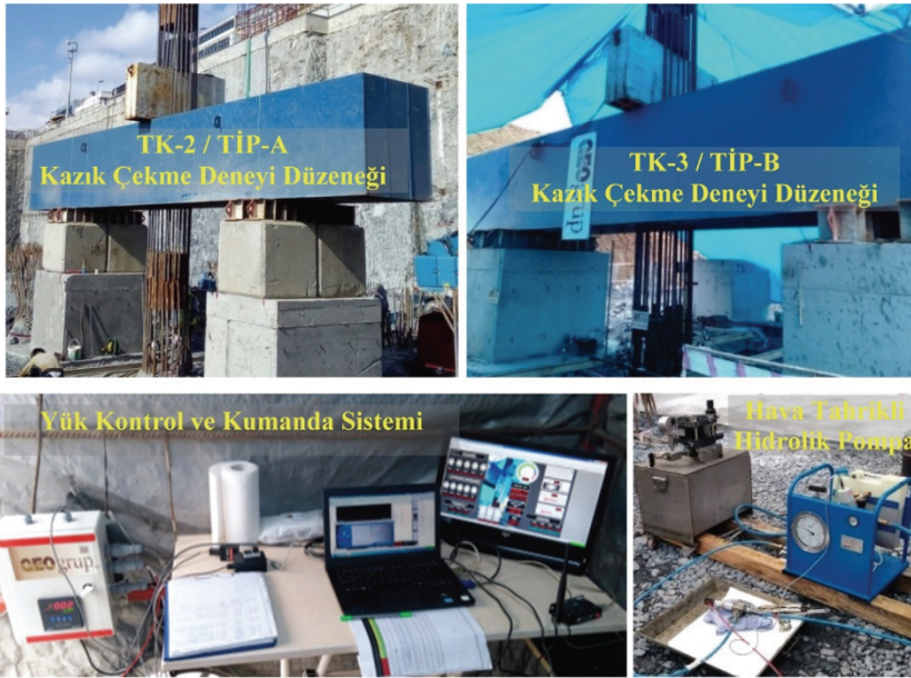
Şekil 7 - Deney düzeneği, yük kontrol ve kumanda sistemi ve hidrolik pompa genel görünüşü
