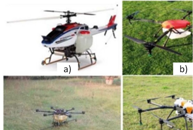
Şekil 9. İHA püskürtücüler (a) Tek rotorlu İHA püskürtücü (b) Dört rotorlu İHA püskürtücü (c) Altı rotorlu İHA püskürtücü (d) Sekiz rotorlu İHA püskürtücü (Karaköy & Çilesiz, 2022).
