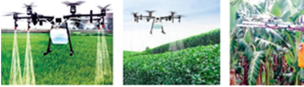
Şekil 8. (a) Çeltik tarlasında (b) Çay mahsulünde ve (c) Muz ağaçlarında kullanılan İHA tabanlı ilaçlama sistemi (Hafeez vd., 2022).
