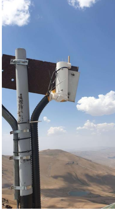
Şekil 1. DAG yerleşkesinde bulunan Boltwood Bulutluluk Sensörü
