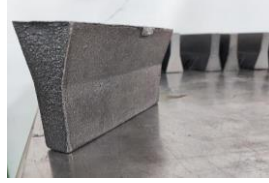
Şekil 4. Döküm yoluyla üretilen Y-Blokler (Y-Blocks produced by casting)
