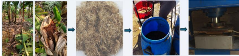
Figure A: Board production process / Şekil A: Levha üretim süreci
