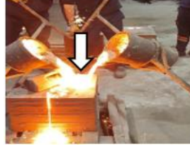
Şekil 1. LGDD ve KGDD'in tek yolluktan döküm işlemi (Single guide casting process of lamellar and spherical graphite cast iron)
