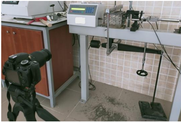
Şekil 3. Modifiye direkt kesme sistemi (Modified direct shear system)
