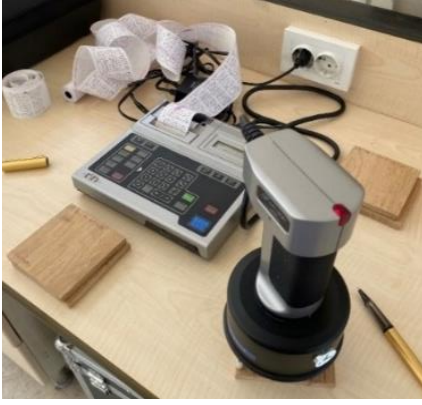
Resim 1.2. “MINOLTA CR-231” renk ölçüm cihazı (“MINOLTA CR-231” color measuring device)
