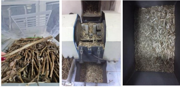
Haşhaş sapları (Poppy stalks) Kırma cihazı (Crushing device) Kırılmış ürün (Crushed product)
