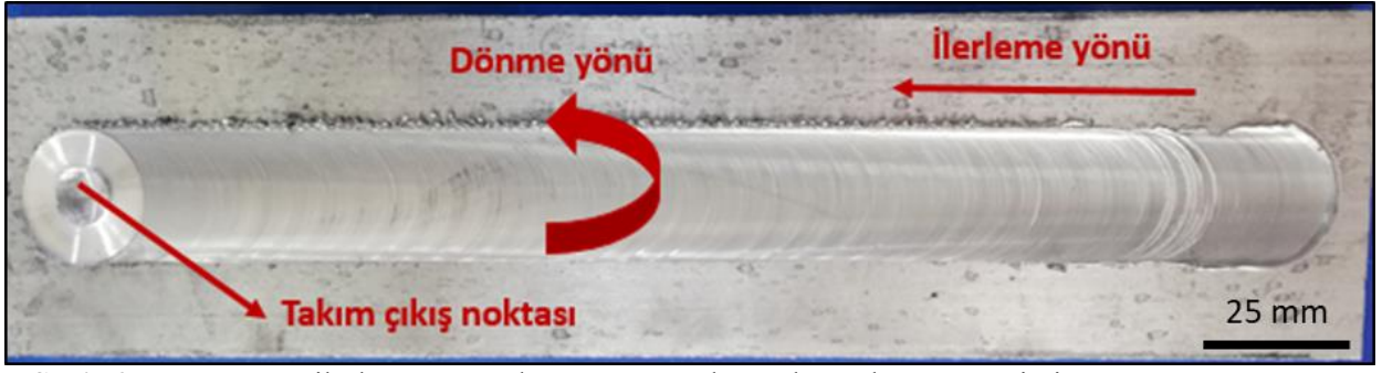
Şekil 6. SKY sonrası ilerleme yönü, dönme yönü, takım çıkış noktası gösterimi (Display of feed direction, rotation direction, tool exit point after FSP)
