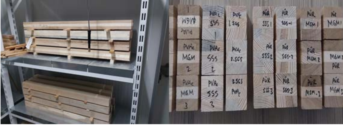
Şekil 2. Lamine keresteleri iklimlendirme kabini içinde kondisyonlanması
