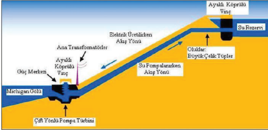
Şekil 7. Basınçlı su depolama şeması (Parrilla ve diğ., 2023)
