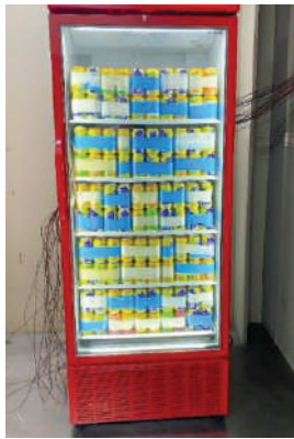
Şekil 3. Testi Gerçekleştirilen Ticari Kutu Soğutucusu
