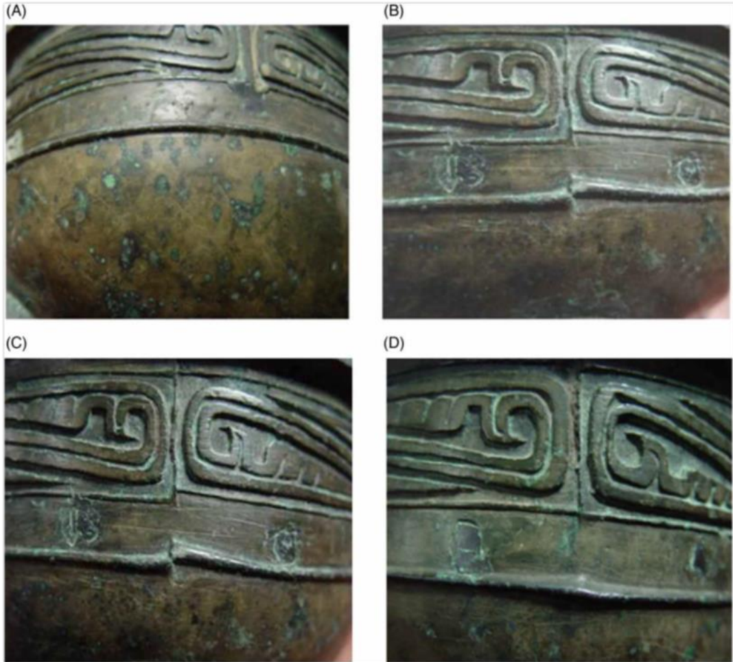
Figür 3: (A) Orijinal patina, (B) Uygulama öncesi yüzey, (C) Uygulama sonrası, (D) Uygulamadan 5 yıl sonrası (Wang et al. 2014).
