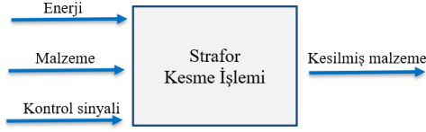
Şekil 1. CNC strafor kesme makinesi ana fonksiyonu [22].
