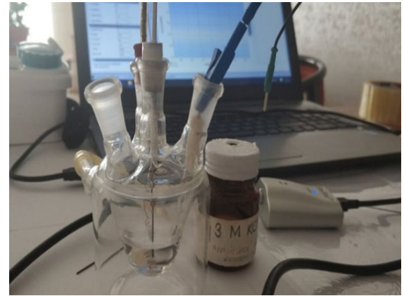
Şekil 4. Referans elektrot olarak Ag/AgCl (3M KCl), karşıt elektrot olarak Pt tel ve çalışma elektrodu olarak KUE'un kullanıldığı üç elektrotlu klasik bir sistem.
