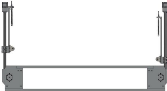
Şekil 9. Tel gerdirme aparatı montajlı hali CAD çizimi.
