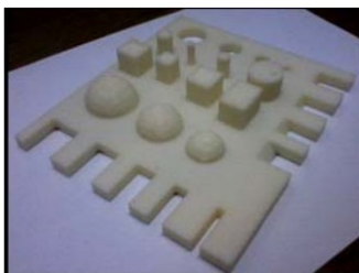
Şekil 2. FDM yazıcı kullanılarak baskı alınan test objesi [11]
