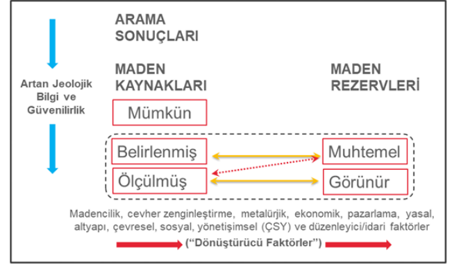
Şekil 4. Arama Sonuçları, Maden Kaynakları ve Maden Rezervleri Arasındaki Genel İlişki (UMREK, 2023)
