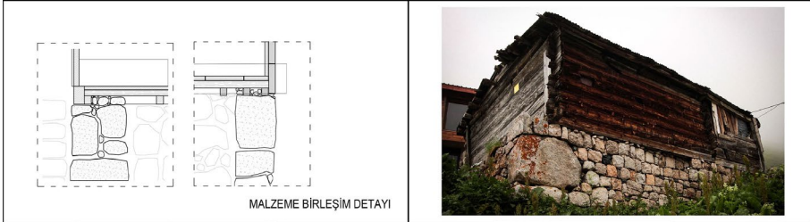
Şekil 19. Taş ve ahşap birleşim detayı (Kaynak: Yazarlar).
