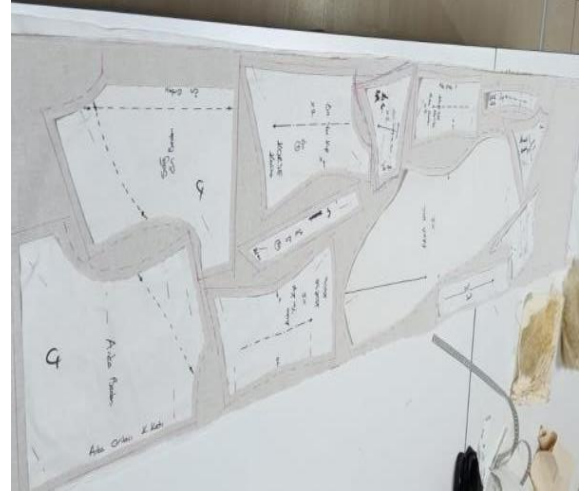
Şekil 14. Kumaş eni ölçülerek (43 cm) pastal planının hazırlanması Figure 14. Preparing the marker plan by measuring the fabric width (43cm)
