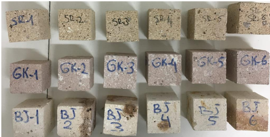
Şekil 2. Kapiler su emme özellikleri belirlenen ignimbirit numuneleri.
