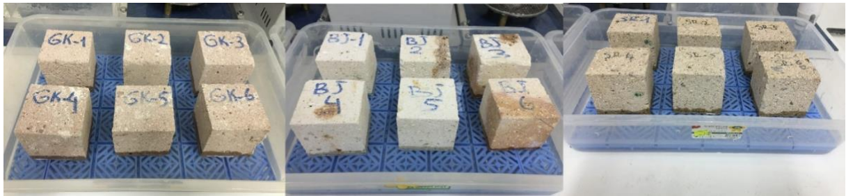
Şekil 3. Kapiler su emme deneyine tabi tutulan iğnimbirit numuneleri.
