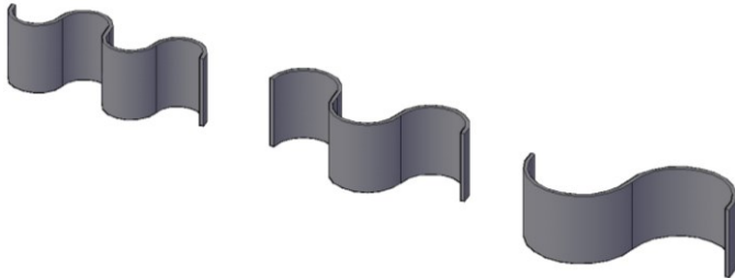
Şekil 8. Deneyleri ve nümerik modelleri oluşturulan harmonik dizilimdeki dairesel labirent savaklar
