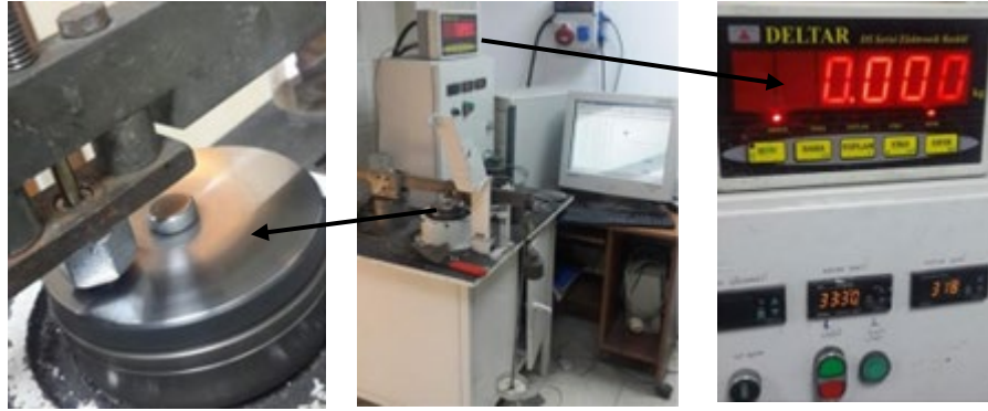
Şekil 1. Pim-disk aşınma test cihazı
