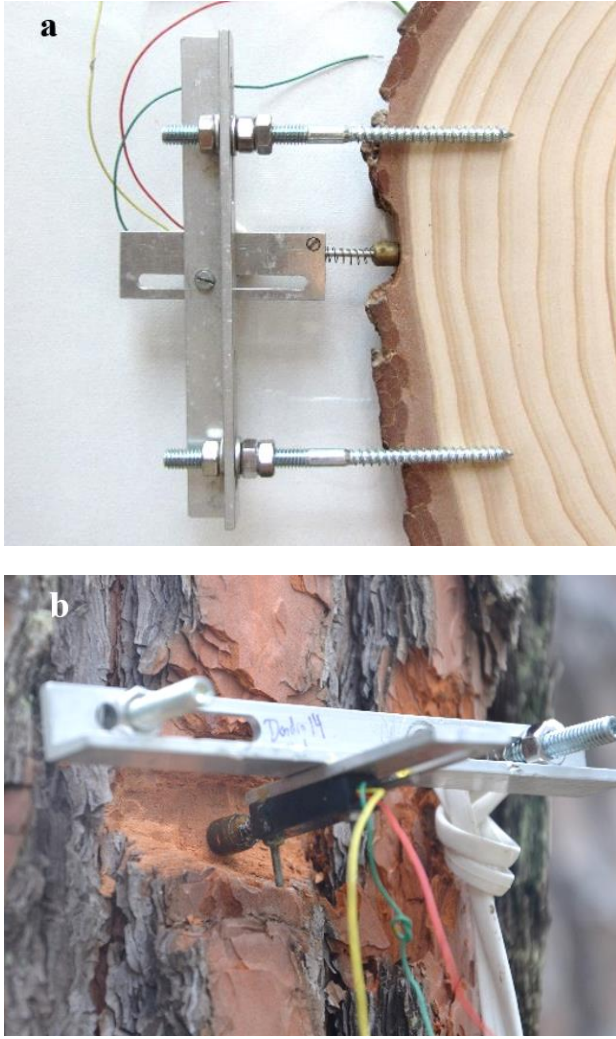
Şekil 3. Nokta dendrometrenin montaj prensibi. a) Dendrometre çelik bir çerçeve üzerine monte edilir ve ksilem içine iki vida ile gövdeye tutturulur. b) Kabuğun çoğunluğu kaldırıldıktan sonra gövdenin korteks yüzeyine dendrometrenin başlığı yerleştirilir
