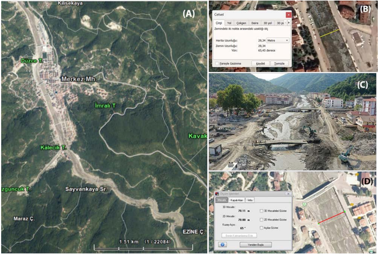
Şekil 3: Ezine Çayı'nın Bozkurt yerleşmesi bölümünde (URL 5), 11 Ağustos 2021 seli öncesindeki ve sonrasında yeni yapılan taşkın koruma projesi kanal genişlikleri (1. Kanal genişliği görüntü tarihi 07 Şubat 2021 ve 2.Kanal genişliği görüntü tarihi 07 Ocak 2023).
