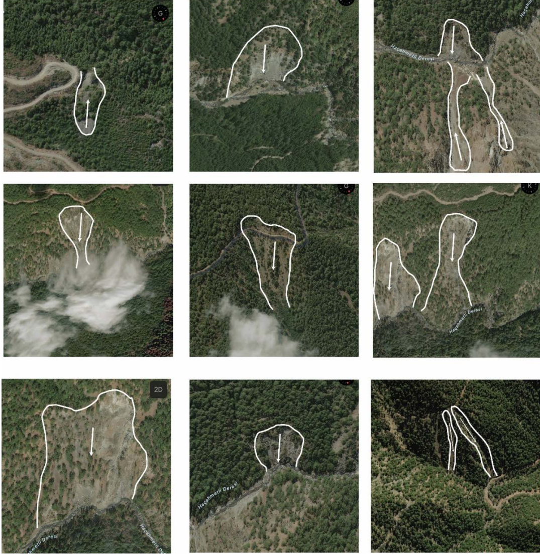
Şekil 2: Arsuz Çayı Havzası'nda yüksek eğimli dik yamaçlar ve vadiler üzerinde meydana gelen farklı türde kütle hareketleri ( https://www.apple.com/maps/ ) / Figure 2: Different types of mass movements occurring on high-slope steep slopes and valleys in the Arsuz Stream Basin ( https://www.apple.com/maps/ ).
