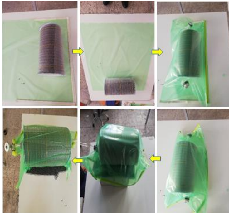
Şekil 4. Hazırlanan numuneye reçine emdirilme işlemi. Figure 4. Resin impregnation process of the prepared sample.
