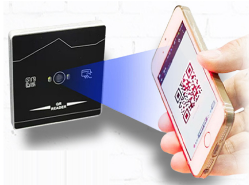
Figure 4. Barcode Access System (Barkodlu Geçiş Sistemi)
