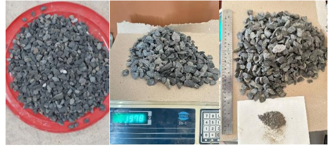
Şekil 8. Bazalt agregasının donma çözülme deneyi
