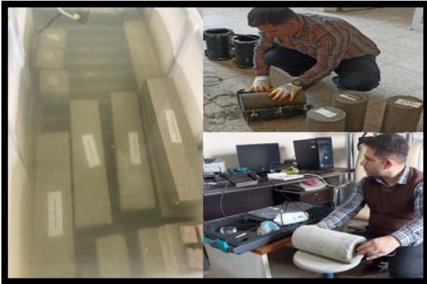
Şekil 2. Kiriş ve Silindir Numuneler ile UPV testi
