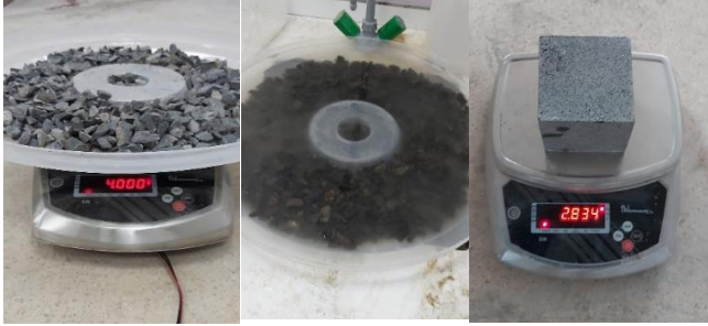
Şekil 7. Bazalt, su emme oranı ve birim hacim kütle deneyi
